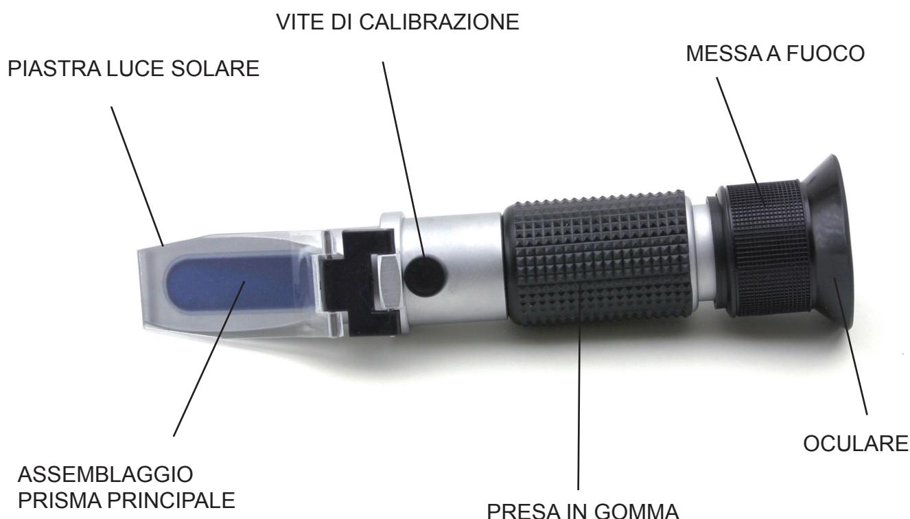
La serie HR-170 è stata sviluppata per verificare la concentrazione di fluidi per batteria, di liquidi antigelo e per la pulizia. Grazie a questo strumento si può stabilire a quale temperatura fluidi antigelo, come glicol propilene e glicol etilenico, congelano. Può anche essere usato per verificare la carica di batterie a soluzione elettrolita.
