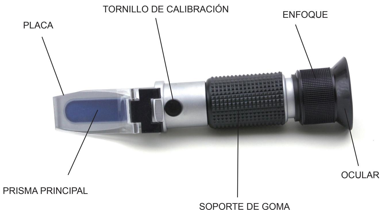
La serie HR-180 está indicada para el análisis del vino. Puede ser utilizada para medir la concentración de alcohol en el vino y determinar el contenido de azúcares en el mosto.
