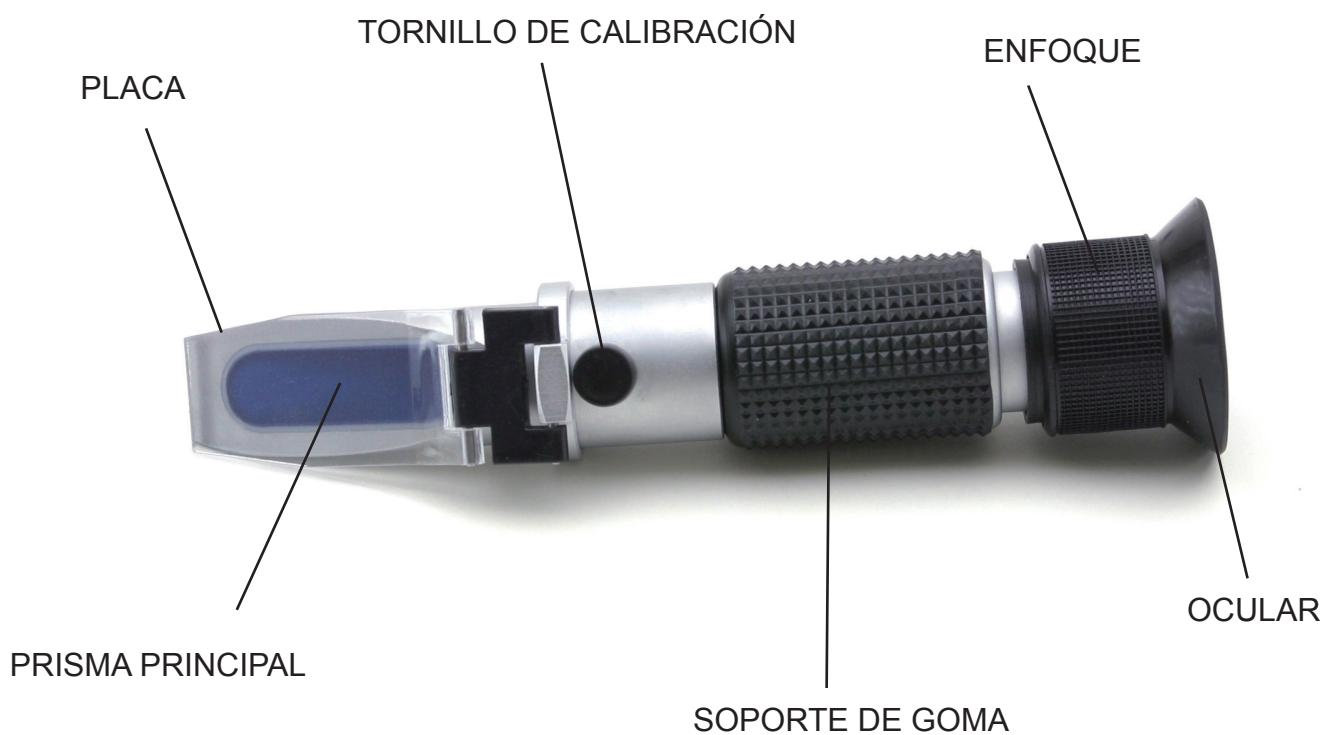
La serie HR-190 está indicada para medir la concentración de agua salada y salmuera. Junto al refractómetro se incluye un pequeño destornillador y una pipeta para analizar los líquidos.
