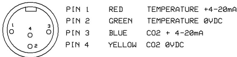
SOLDER VIEW OF CABLE SOCKET
