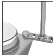
注意：对于直径超过 180 mm 的容器，请将支杆结合延伸支杆使用(见“选配件”)。
