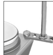
Note: Lors de l'utilisation de fixations pour le bain d'un diamètre supérieur à 180 mm, veuillez utiliser une tige de support avec une extension. (Voir « Accessoires »)
