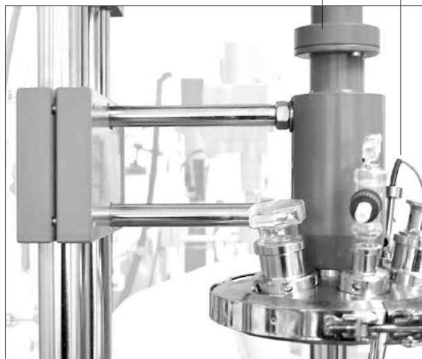
Accessoire de montage de l'agitateur de laboratoire avec roulement d'arbre d'agitation.
