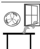
Ne pas les placer près de fenêtres ouvertes, climatisation, ventilateurs, qui pourraient causer des courants d'air et donc des lectures instables.
