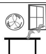
Non collocare vicino a finestre aperte o ventole per il condizionamento dell'aria che potrebbero causare letture instabili a causa delle correnti d'aria
