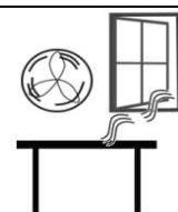
No la coloque cerca ventanas abiertas, aberturas de aire acondicionado o ventiladores que pueden causar lecturas inestables.
