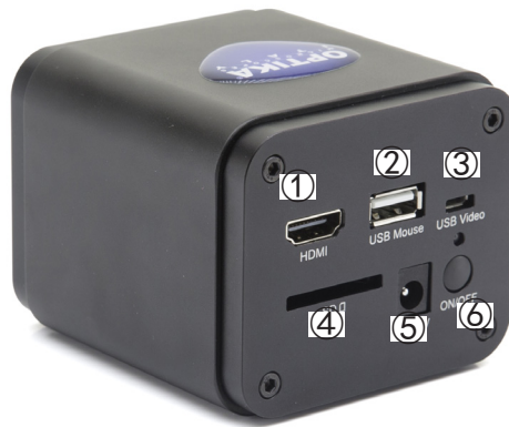
Figura 1 - Pannello posteriore della C-HP
