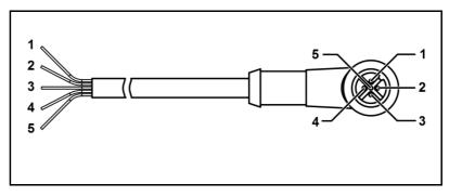
Fig. 1: RC cable pins
