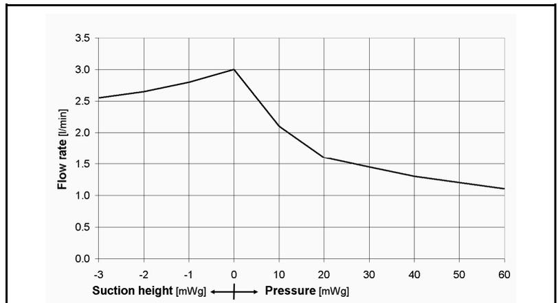
Fig. 4: Flow rate curve for Liquipor<sup>®</sup> 1.300
