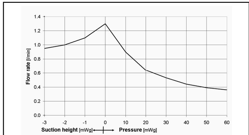
Fig. 2: Flow rate curve for Liquiport® 1.100
