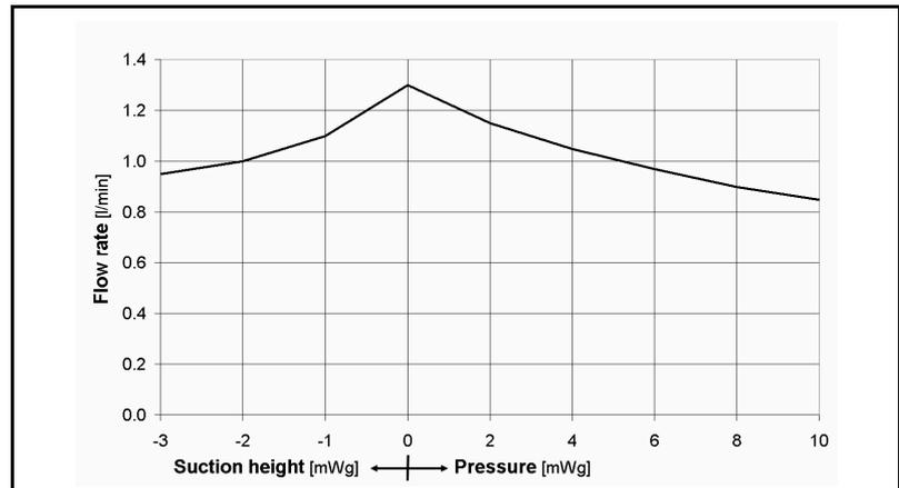
Fig. 1: Flow rate curve for Liquiport® 100
