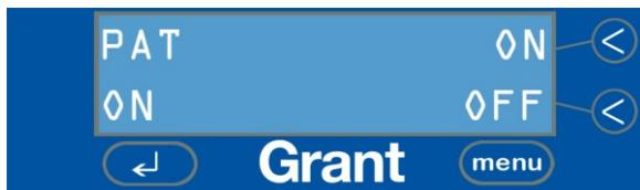
Beim Drücken auf ON werden Heizung und Ultraschallgenerator unabhängig von den Programmeinstellungen eingeschaltet.
