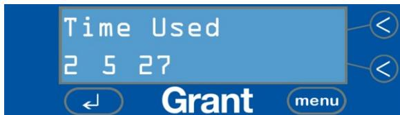
Per esempio, la schermata qui sopra indica che il bagno è stato utilizzato per un totale di 2 giorni, 5 ore e 27 minuti.
