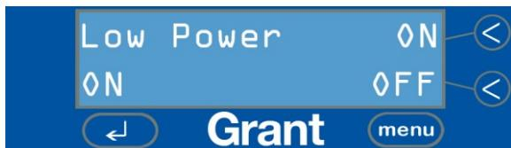
Durch Setzen von LOW POWER auf ON schaltet das Grant Digital Ultraschallbad nach 5 Minuten Inaktivität in den SLEEP-Modus, d. h. das Display und die interne Wasserheizung werden abgeschaltet.
