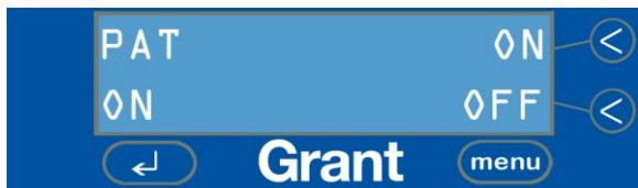
Lorsque le bouton ON (Marche) est sélectionné, le bloc chauffant et le générateur des ultrasons s'activent, sans tenir compte des autres réglages programmés.
