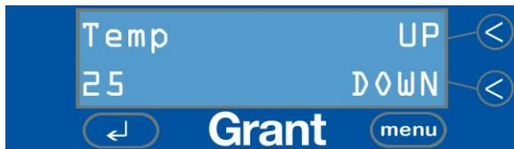
Die gewünschte Temperatur der Reinigungsflüssigkeit kann mit Taste 3 und 4 im Bereich von umgebungstemperatur+5°C und 70°C eingestellt werden.
