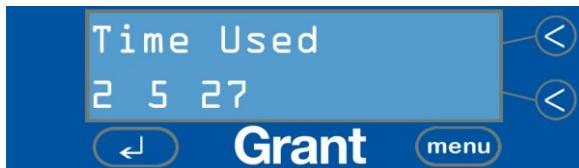
So ist beispielsweise der obigen Abbildung zu entnehmen, dass das Bad insgesamt 2 Tage, 5 Stunden und 27 Minuten in Betrieb war.
