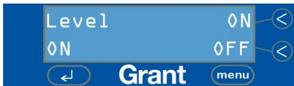
Le capteur de niveau est un dispositif résistif, par conséquent il ne détectera pas les liquides ayant une très faible conductivité tels que l'eau déionisée pure.
