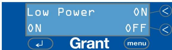
En activant la fonction d'économie d'énergie, le bain à ultrasons numérique Grant passe en mode VEILLE après 5 minutes d'inactivité - l'éclairage de l'écran diminue et le chauffage interne du bain s'arrête.
