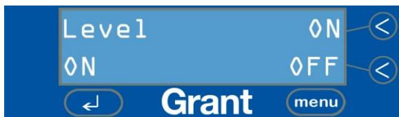
El sensor de nivel es un dispositivo resistivo, por lo que no detecta líquidos con muy poca conductividad, como el agua pura desionizada (DI).
