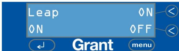
Die gewünschte Option kann mit den Tasten 3 und 4 ein- bzw. ausgeschaltet werden.
