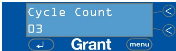
Der Programmlaufzähler zeigt die bereits abgeschlossenen und die vom Bediener bzw. durch niedrigen Flüssigkeitsstand abgebrochenen Programme an.
