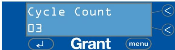
Le comptage inclut tous les cycles que le bain a lancé y compris ceux qui n'ont pas été terminés, c'est-à-dire les cycles interrompus par l'opérateur ou interrompus en raison du niveau bas de liquide.
