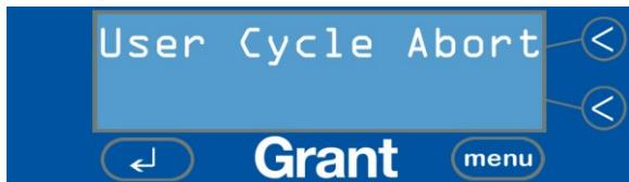
Si el sensor de nivel está activado y durante el funcionamiento la cantidad de líquido desciende por debajo del nivel necesario, el ciclo de limpieza se detiene y aparece la pantalla siguiente.
