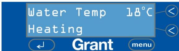
Quando la temperatura dell'acqua è pari o superiore alla temperatura impostata, appare il messaggio "Temp OK" (Temperatura corretta).
