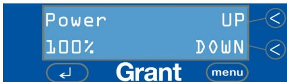
Utilice las teclas ARRIBA y ABAJO para aumentar o disminuir los dígitos entre 50 y 100%. Una vez seleccionado el nivel de potencia correcto, utilice la tecla MENU para pasar a la pantalla siguiente.
