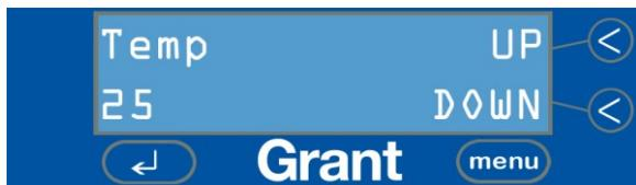
Les touches UP (Haut) et DOWN (Bas) permettent de régler avec précision la température voulue du liquide de nettoyage, comprise entre ambiante+5 et 70 °C.
