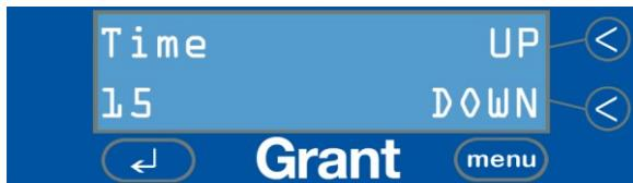
Una vez seleccionada la duración de ciclo correcta, utilice la tecla MENU para pasar a la pantalla siguiente. Este ajuste se conservará hasta que lo vuelva a modificar en el menú del operador.
