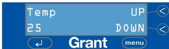
Utilizzare i tasti UP (Su) e DOWN (Giù) per impostare con precisione la temperatura del liquido di lavaggio tra ambiente +5 °C e 70 °C.
