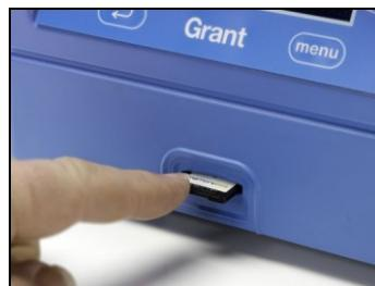
Registrando i parametri del ciclo di lavaggio sulla scheda SD e trasferendoli ad un PC è possibile ottenere una registrazione elettronica permanente di tali parametri.
