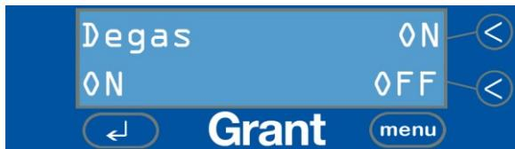
Die gewünschte Option kann mit den Tasten 3 und 4 ein- bzw. ausgeschaltet werden. Eine Erläuterung der Notwendigkeit einer Entgasung finden Sie auf Seite 23.
