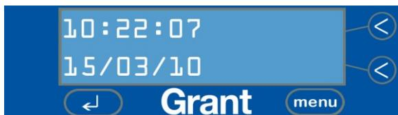
Si desea cambiar la fecha y la hora, pulse la tecla MENU para desplazarse por las opciones y utilice las teclas ARRIBA y ABAJO para efectuar los cambios. Una vez seleccionados los valores correctos, utilice la tecla MENU para pasar a la pantalla siguiente.
