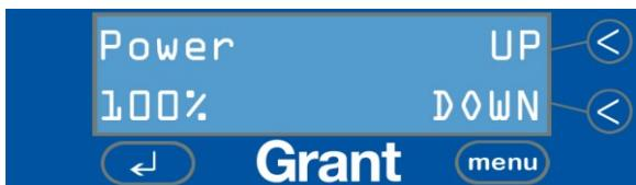
Les touches UP (Haut) et DOWN (Bas) permettent de faire défiler les chiffres compris entre 50 et 100 %. Lorsque vous avez sélectionné le niveau de puissance voulu, utilisez la touche MENU pour accéder à l'écran suivant.
