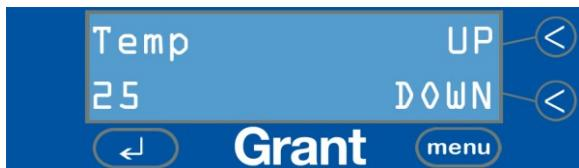
Utilice las teclas ARRIBA y ABAJO para ajustar con precisión la temperatura del líquido de limpieza entre ambiental e + 5 y 70 °C.
