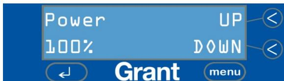
Mit den Tasten 3 und 4 können Sie die Heizleistung zwischen 50 und 100 % einstellen. Nach Auswahl der gewünschten Heizleistung gelangen Sie durch Drücken der MENU-Taste zum nächsten Display.
