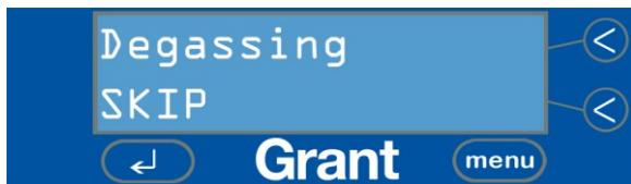
Quando si ritiene che il liquido sia sufficientemente degassato, premere il tasto ←.
