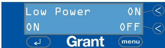
Si se activa el ahorro de energía, a los cinco minutos de inactividad el baño entra en modo de espera (SLEEP): la iluminación del visor se atenúa y el calentador de agua interno deja de funcionar.
