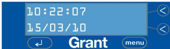
Gehen Sie zum Einstellen von Datum und Uhrzeit durch wiederholtes Drücken der MENU-Taste zur Zeiteinstellung und stellen Sie Werte durch Betätigen der Tasten 3 und 4 ein. Nach Auswahl der gewünschten Einstellungen gelangen Sie durch Drücken der MENU-Taste zum nächsten Display.
