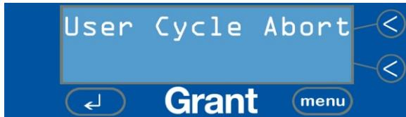
Wenn der Füllstandssensor eingeschaltet ist und der Flüssigkeitsstand während des Betriebs unter den erforderlichen Pegel fällt, wird das Reinigungsprogramm abgebrochen und auf dem Display Folgendes angezeigt:
