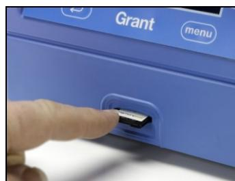
Grâce à l'enregistrement des paramètres sur une carte SD et leur transfert sur un ordinateur, un enregistrement électronique permanent des paramètres de cycle de nettoyage est sauvegardé.
