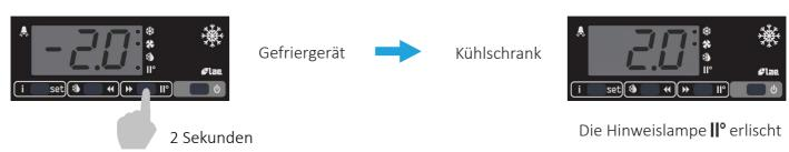
Wiederholen Sie die Anleitungen oben, um vom Kühlschrank zum Gefriergerät zu wechseln.
