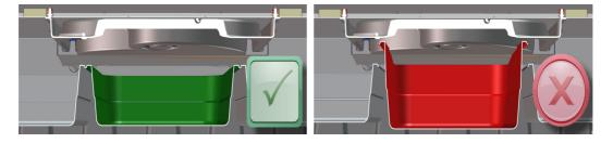
De luchttoevoer van de ventilator **NIET** blokkeren
