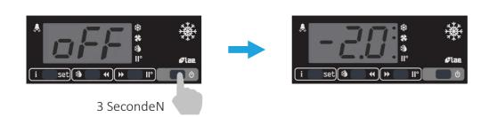
Opmerking: indien u de toets 5 seconden lang indrukt en dan loslaat, wordt een 'testsequentie' uitgevoerd (zie onderstaande instructies).
